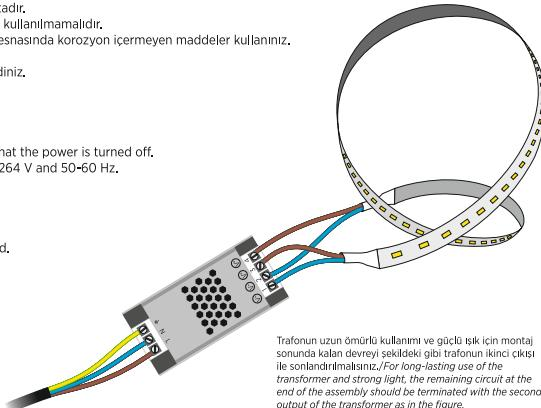
Trafonun uzun ömrülü kullanımı ve güçlü ışık için montaj sırasında kalan devreyi şekildeki gibi trafon ikinci çıkış ile sonlandırınmakantedir. For long-lasting use of the transformer and strong light, the remaining circuit at the end of the assembly should be terminated with the second output of the transformer as in the figure.
